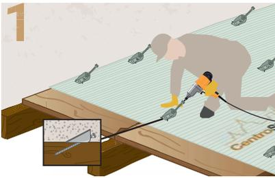
Mettere a nudo l'assito/pianelle in cotto e stendere Membrana CentroStorico. Fissare le viti nei due fori più allungati del Connettore alla trave mediante l'avvitatore con inserto da 13 mm. In caso di legni duri, eseguire il preforo con un trapano punta  $\varnothing$  6 mm.
