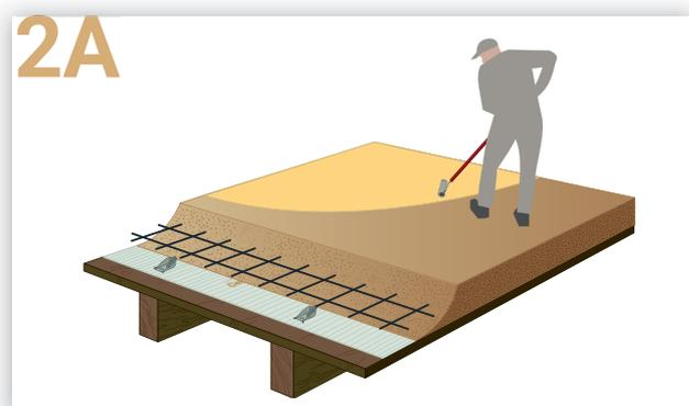
Stendere due mani di Primer (a distanza di 12-24 h) con una pennellessa o un rullo a pelo corto in funzione delle esigenze del supporto (assicurarsi di aver realizzato una superficie continua e priva di pori). Procedere con lo spolvero di sabbia secca sulla mano finale di Primer ancora allo stato fresco.
