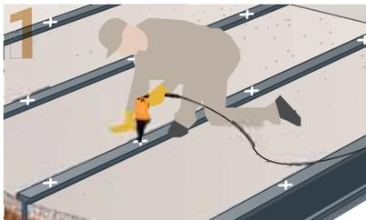
Segnare le distanze a cui vanno posizionati i connettori. Eseguire un preforo con un trapano e una punta da 8 mm, in modo da attraversare lo spessore dell'ala della trave.
