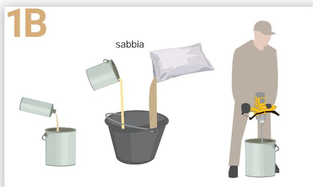
Versare il componente B nel recipiente del componente A e mescolare. Versare il composto in un recipiente con sabbia silicea in rapporto 1:1 - 1:10 (in funzione della riparazione da effettuare) e mescolare.
