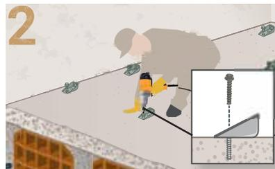
Fissare le viti inserite nel foro circolare del connettore al calcestruzzo mediante l'avvitatore (meglio se a impulsi) con bussola esagonale da 13 mm.
