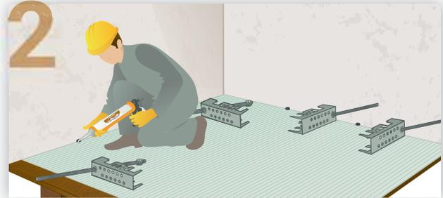
2 Pulire il foro (con pistola ad aria compressa, scovolino metallico, aspirazione) e riempirlo con Ancorante Chimico sino a circa i 3/5 della profondità, posizionando la cartuccia dentro la "pistola" applicatrice (tipo silicone).
